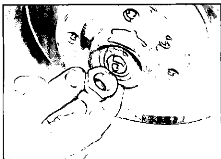
obr. 2.4 Odšroubujeme nábojovou matici kola a sejmeme ji i s podložkou
