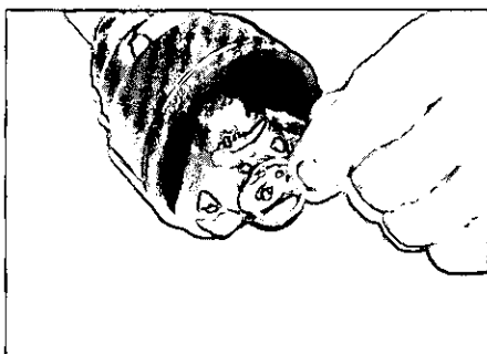
obr. 3.31 Vyrovnáme rysky nakreslené před demontáží, nasadíme hvězdicí kloubu a zajistíme ji novým pojistným kroužkem
