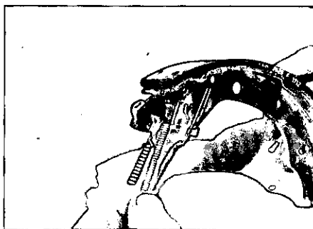
obr. 5.18a Zahákneme horní vratnou pružinu do náběžné čelisti...
