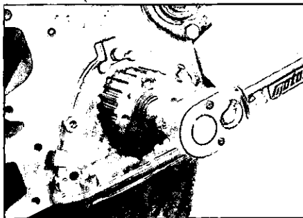
obr. 5.24b ...utáhneme ho předepsaným momentem...
