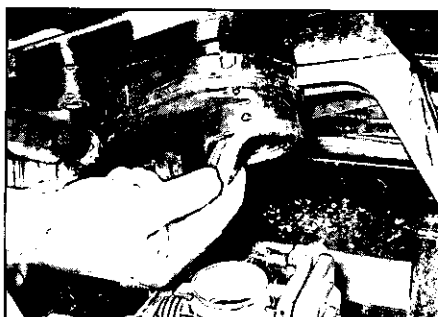
obr. 2.14 Při montáži tělesa škrtkové klapky zkontrolujeme stav gumového těsnění
