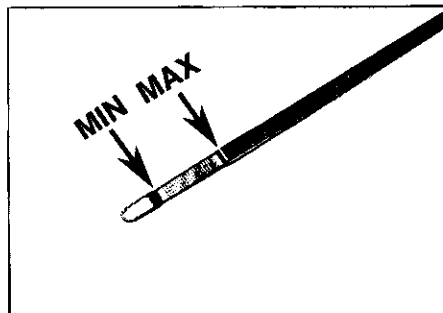
obr. 3.16b ...a doplníme olej až po značku MAX na měrné tyči
